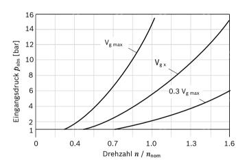
Dieses Diagramm gilt nur für den optimalen Viskositätsbereich von  $v_{\rm opt}$  = 36 bis 16 mm²/s.
